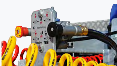
Valve de desserage des freins
